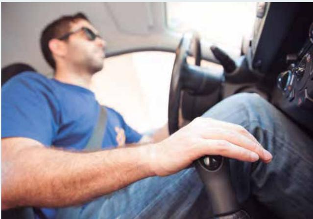
ducirse en holguras, marchas que se resisten a entrar o que se salen e incluso rotura. Recuerde, las manos siempre en el volante y solo en la palanca cuando vaya a cambiar de marcha. Además, así tiene capacidad de maniobra sobre el volante.
